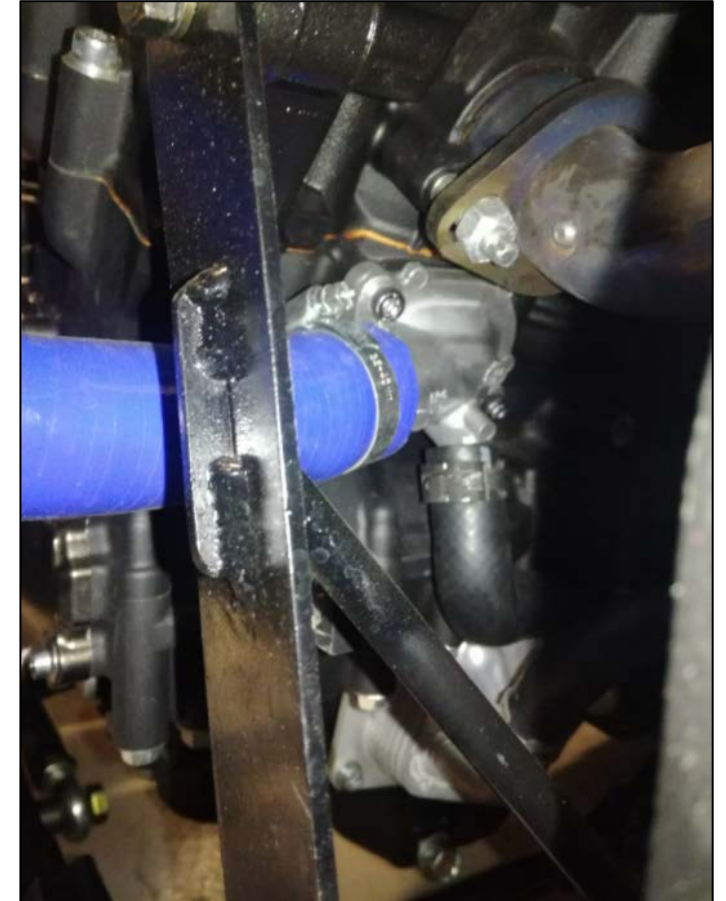
Kuva-B2, Vasen puoli -vahvistushitsattu polvirauta palalla
